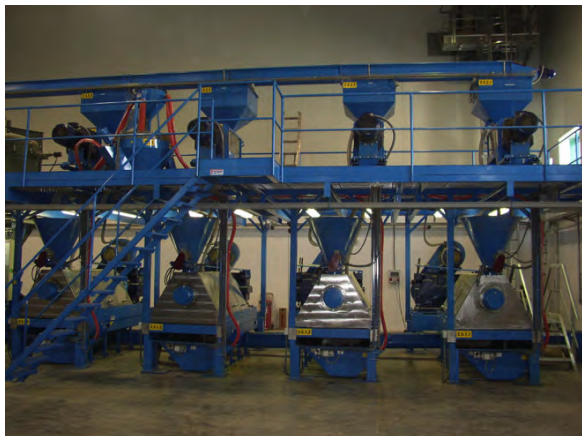
FIGURA 123. SISTEMA DE PENSADO EN FRÍO DE ACEITE DE ALMENDRAS. FARMET
