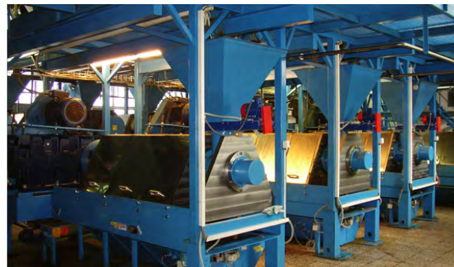
FIGURA 115. SISTEMA DE Prensado CALIENTE DE ALMENDRAS PARA ACEITE REFINADO. FARMET
