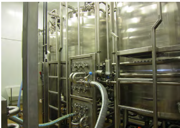
FIGURA 94. SISTEMA DE PASTEURIZACIÓN DE LECHE DE ALMENDRAS. KQDE FOOD
