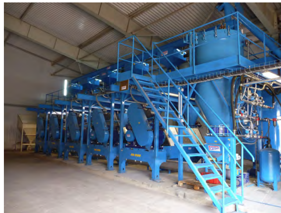
FIGURA 122. SISTEMA DE PENSADO EN FRÍO DE ACEITE DE ALMENDRAS. FARMET
