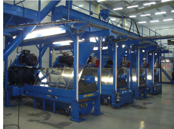
FIGURA 118. SISTEMA DE PENSADO EN FRÍO DE ACEITE DE ALMENDRAS. FARMET
