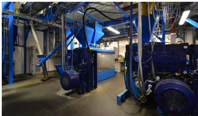
FIGURA 114. SISTEMA DE Prensado CALIENTE DE ALMENDRAS PARA ACEITE REFINADO. FARMET
