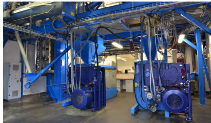
FIGURA 124. PENSAS DE NUEVA GENERACIÓN DE PENSADO DE ALMENDRAS PARA ACEITE. FARMET
